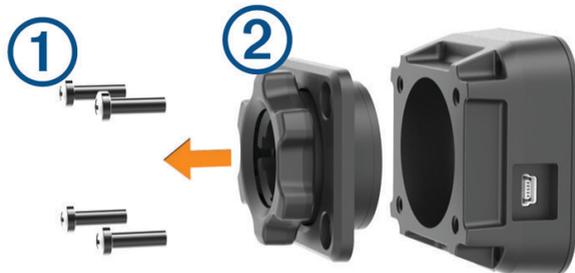
2 Снимите гнездо крепления.
