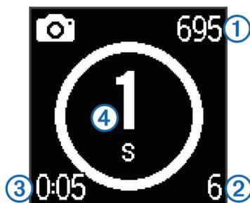
Устройство сделает серию снимков с заданным интервалом времени. На экране отображается оставшееся количество фотографий, которые могут быть сделаны устройством (1), количество сделанных фотографий (2), прошедшее время (3) и время до съемки следующей фотографии в секундах (4).
