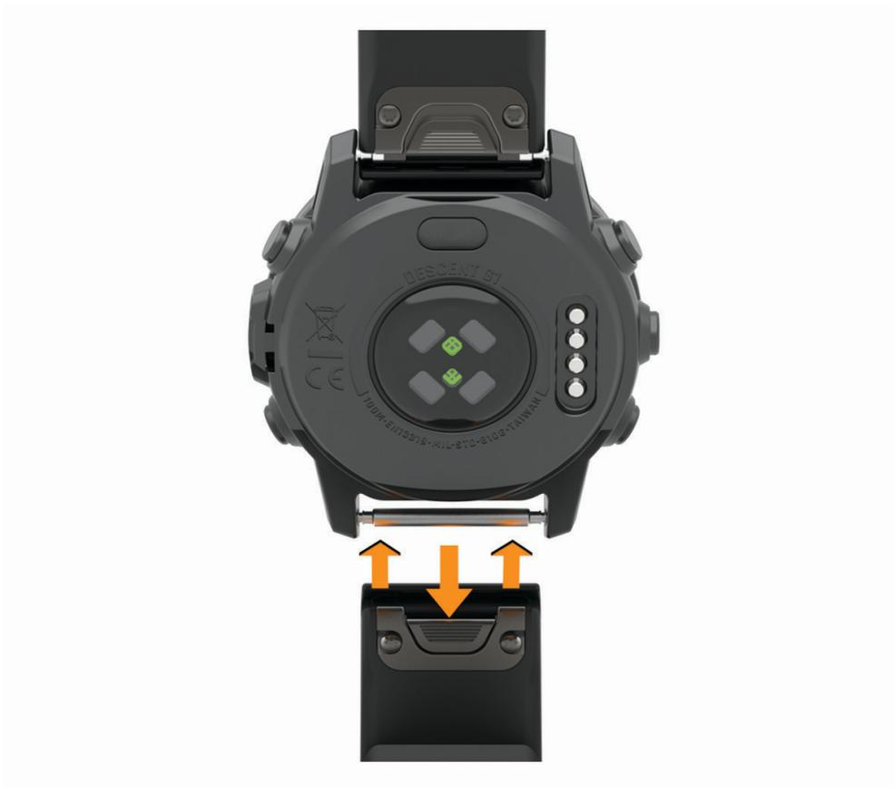
**ПРИМЕЧАНИЕ.** убедитесь, что ремешок закреплен надежно. Фиксатор должен защелкнуться на штырьке часов.
