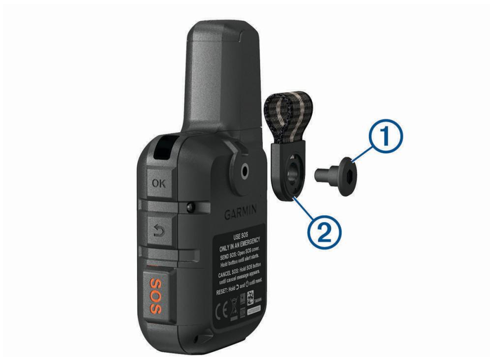
2 Закрепите адаптер монтажной панели **1** на задней панели устройства с помощью длинного винта **2**, входящего в комплект устройства.
