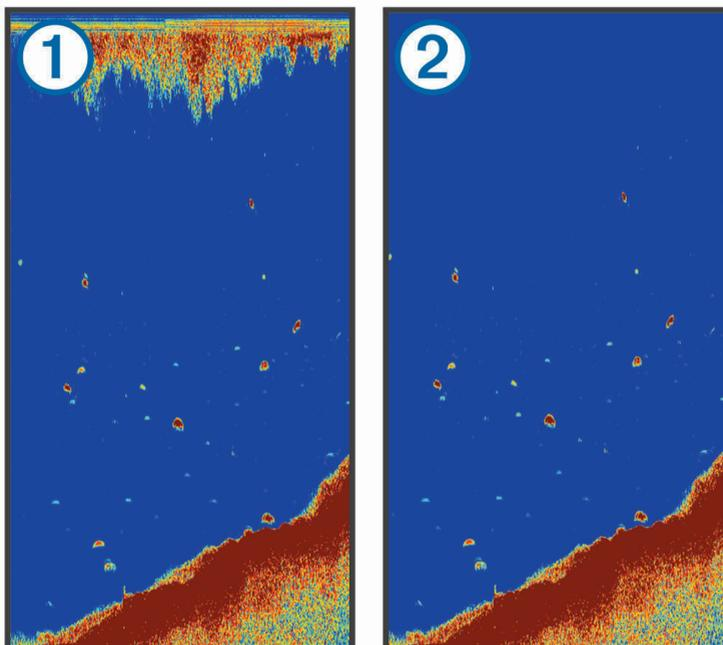
К возникновению шума поверхности ① приводят принимаемые датчиком помехи от поверхности воды. Чтобы уменьшить количество помех, отображаемых на экране, шум поверхности можно скрыть ②. Использование широких лучей (более низких частот) позволяет отобразить больше целей, но может приводить к повышению уровня шума поверхности.
