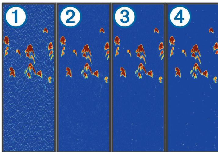
При последовательной установке значения ①, соответствующего выключенному состоянию, минимальной ②, средней ③ и максимальной чувствительности ④ уровень шума постепенно снижается, но это практически не влияет на сильные эхо-сигналы, отраженные от целей. Для удаления помех с экрана следует использовать настройку, максимально снижающую помехи и улучшающую изображение. Чтобы полностью устранить помехи, необходимо исправить проблемы, связанные с установкой устройства.
